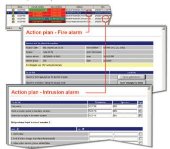
Les plans d'action ou les flux de travail conditionnés par les alarmes fournissent à l'opérateur des informations détaillées (en fonction de l'événement), telles que les procédures standard, des images en temps réel, les boutons de commandes. Il suffit de créer et d'affecter un plan d'action à chaque type d'alarme possible dans votre système, notamment l'alarme incendie, le refus d'accès et les alarmes techniques.
