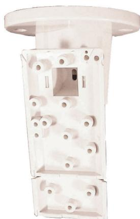
Montez le support plastique B338 en surface au plafond. Il peut être utilisé avec de nombreux types de détecteur. L'angle de pivotement vertical est compris entre  $+7^\circ$  et  $-16^\circ$  ; l'angle de rotation horizontal est de  $\pm 45^\circ$ .
