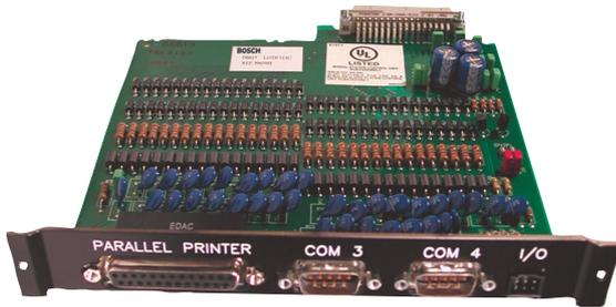
Tableau enfichable modulaire. Offre une interface blindée entre la carte de ligne processeur Conettix D6610 et les connexions externes vers les ordinateurs et imprimantes des bases de données de télésurveillance. Inclut :
