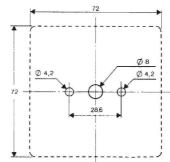
3/ Monter les éléments du KIT, puis fixer dans le panneau de fixation à l'aide des 2 vis diam. M4.
