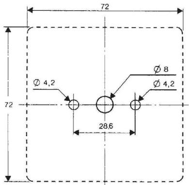
3/ Monter les éléments du KIT, puis fixer dans le panneau de fixation à l'aide des 2 vis diam. M4.
