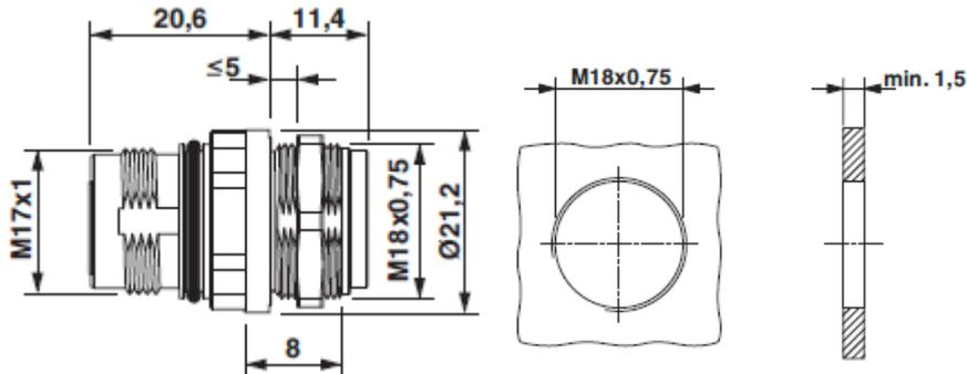
**Benötigte Bohrungen am Gehäuse:**
