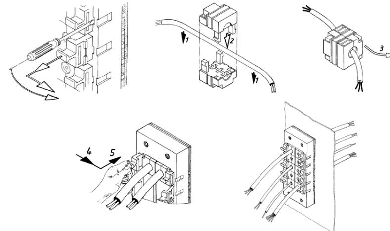
Ausbau Dichtelement / *Disassembly sealing element*
