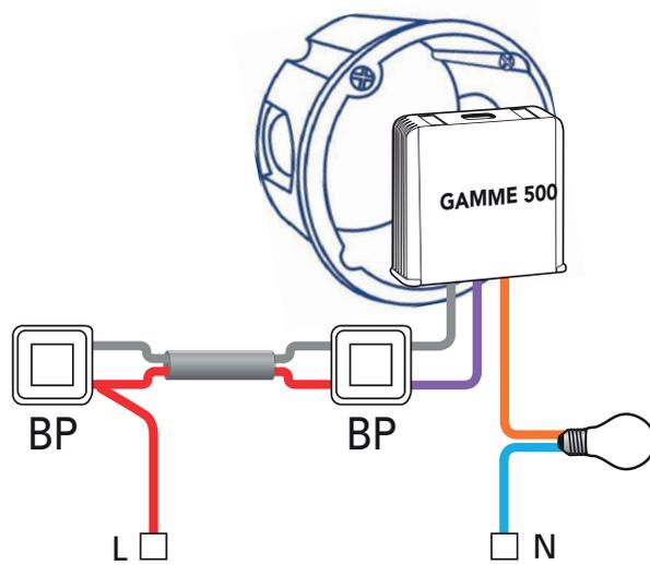
**AUGMENTATION DE LA PUISSANCE SUR UN CIRCUIT AVEC LA SÉRIE 500**
