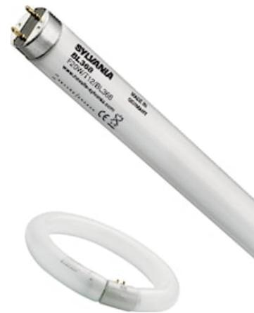
Les tubes BL368 émettent une radiation UV très élevée avec un pic à 368nm. La sensibilité de l'œil des insectes volants est généralement à cette longueur d'onde. Version Toughcoat avec gaine de protection anti-bris de verre. 18" ≈ 438mm ; 24" ≈ 590mm ; 48" ≈ 1200mm.
