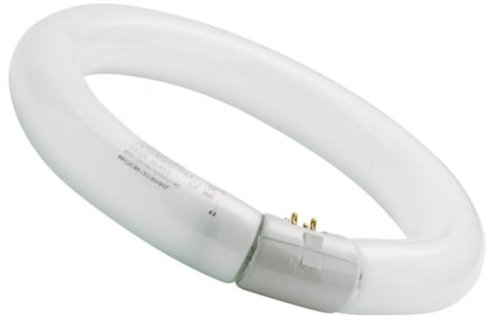
Tube fluorescent circulaire standard T5 et T9. Blanc chaud (830), Blanc neutre (840), et Lumière du jour (865). Éclairage domestique ou commercial. Culot 2Gx13 (T5) - G10q (T9). Fonctionne avec ballast électronique. Durée de vie moyenne : jusqu'à 16.000 heures.
