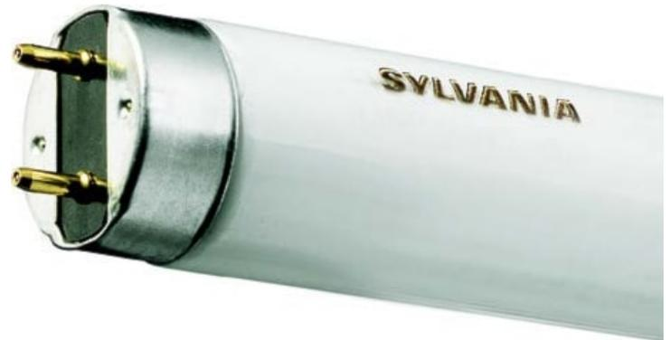
Tube triphosphore T8 - diamètre 26mm. Pour des applications aux dimensions non-standards. Efficacité lumineuse élevée, très bon rendu des couleurs (IRC>80). Durée de vie moyenne : 20.000 heures . Fonctionne avec ballast ferromagnétique ou électronique. Culot G13.
