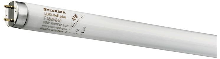
Tube triphosphore T8 - diamètre 26mm. Efficacité lumineuse élevée, très bon rendu des couleurs (IRC>80). Durée de vie moyenne : 20.000 heures . Fonctionne avec ballast ferromagnétique ou électronique. Culot G13.
