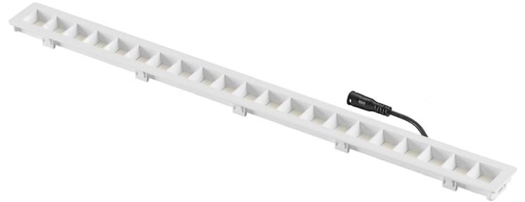
Module LED de remplacement pour l'OptiClip. Version 1 câble de connexion. Flux max 1900lm sous 450mA. IRC80, 3000K, SDCM $\leq$ 3.
