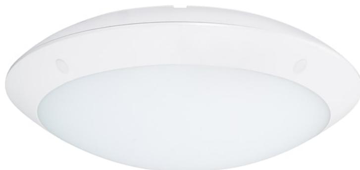
START Surface IP66 12W 1250lm 840 Blanc - Hublot IP66 pour l'éclairage extérieur résidentiel ou commercial. Finition blanche. Flux lumineux : 1250lm avec une efficacité de 104lm/W. Température de couleur : 4000K, IRC>80. Durée de vie version standard (L80) : 78.000h. IP66, IK10 livré avec vis anti-vandal. Classe II. 650°C. Groupe de risque photobiologique : GR0. Diamètre 300. Garantie 5 ans. Sylvania est signataire de la charte LED.
