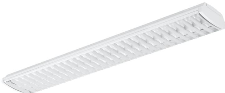
Plafonnier traditionnel équipé de tubes LED T8 remplaçables, pour le remplacement des Sylmaster Fluo 2x36W. Equipé de 2 tubes LED ToLEDo Superia T8 CCG. Flux lumineux 4350lm. Puissance 34W. Efficacité lumineuse 128lm/W. IP20 / IK02. Classe I. Dimensions : 1250 x 202 x 85 mm. Durée de vie 75 000 heures (L70B5). Garantie 5 ans.
