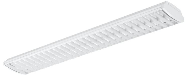
Plafonnier traditionnel à équiper de 2 tubes LED T8, pour le remplacement des Sylmaster Fluo. Tubes à commander séparément. Ne contient pas de driver. Les tubes à intégrer doivent être compatibles avec le branchement direct (220-240V AC). Compatible avec les tubes LED ToLEDo Avant T8 CCG. IP20 / IK02. Classe I. Dimensions : 1250 x 202 x 85 mm.
