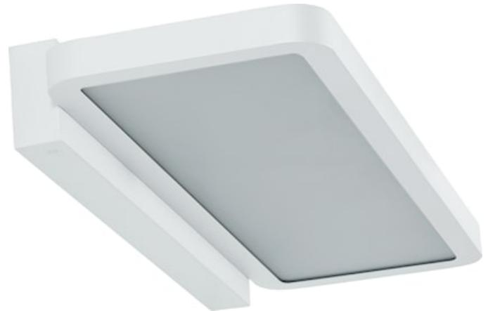
Luminaire LED mural au design discret et élégant, avec distribution directe / indirecte (40% / 60%) de l'éclairage. Corps en aluminium, longueur 600mm, largeur 200mm. Finition blanche (RAL9016). Diffuseur microprismatique (UGR<16). Flux lumineux 5850lm, efficacité lumineuse 130lm/W. IRC>80. 4000K. SDCM < 3. Classe I. Test au fil incandescent 650°C. Durée de vie 100 000 h (L80B10). Garantie 5 ans.
