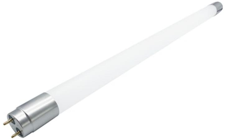
Tube LED T8 avec spectre UV-A optimisé (370nm) pour les applications de lutte contre les insectes. Compatible ballasts magnétiques (CCG) ou branchement direct 230V. Environ 75 % d'économie d'énergie par rapport aux lampes fluorescentes traditionnelles. Angle de faisceau 180°. Intensité du rayonnement UV : 400 mW/m<sup>2</sup> à 1m. Durée de vie 20 000 heures. Garantie 2 ans.
