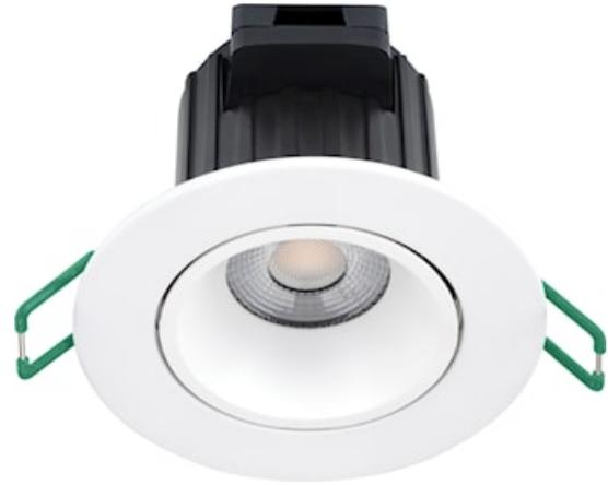
Start Spot Alu 8,7W 870lm 827/830/840 IP44 DIM Blanc - Spot d'accentuation LED offrant une grande efficacité lumineuse. Version IP44 orientable, angle de faisceau 50°. Flux lumineux 870lm, efficacité lumineuse 100lm/W. Dimmable par variation à coupure de phase. 3 températures de couleur 2700/3000/4000K sélectionnables sur le driver. IRC80. Hauteur 62,3mm, diamètre d'encastrement 68mm. Bornier repiquable LILO. Durée de vie 100 000 heures (L70B50). Garantie 5 ans.
