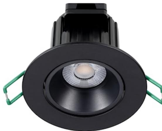
Start Spot Alu 8,7W 760lm 827/830/840 IP44 DIM Noir - Spot d'accentuation LED offrant une grande efficacité lumineuse. Version IP44 orientable, angle de faisceau 50°. Flux lumineux 760lm, efficacité lumineuse 87lm/W. Dimmable par variation à coupure de phase. 3 températures de couleur 2700/3000/4000K sélectionnables sur le driver. IRC80. Hauteur 62,3mm, diamètre d'encastrement 68mm. Bornier repiquable LILO. Durée de vie 100 000 heures (L70B50). Garantie 5 ans.
