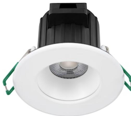
Start Spot Alu 8,7W 870lm 827/830/840 IP65 DIM Blanc - Spot d'accentuation LED offrant une grande efficacité lumineuse. Version IP65 fixe, angle de faisceau 50°. Flux lumineux 870lm, efficacité lumineuse 100lm/W. Dimmable par variation à coupure de phase. 3 températures de couleur 2700/3000/4000K sélectionnables sur le driver. IRC80. Hauteur 62,3mm, diamètre d'encastrement 68mm. Bornier repiquable LILO. Durée de vie 100 000 heures (L70B50). Garantie 5 ans.
