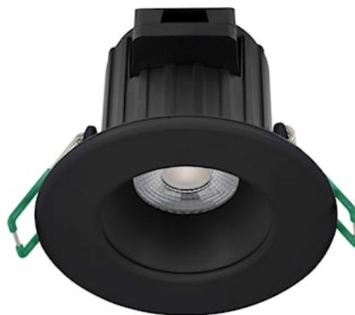
Start Spot Alu 8,7W 760lm 827/830/840 IP65 DIM Noir - Spot d'accentuation LED offrant une grande efficacité lumineuse. Version IP65 fixe, angle de faisceau 50°. Flux lumineux 760lm, efficacité lumineuse 87lm/W. Dimmable par variation à coupure de phase. 3 températures de couleur 2700/3000/4000K sélectionnables sur le driver. IRC80. Hauteur 62,3mm, diamètre d'encastrement 68mm. Bornier repiquable LILO. Durée de vie 100 000 heures (L70B50). Garantie 5 ans.
