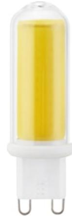
Lampe LED G9 pour le remplacement direct des capsules halogènes Hi-Pin G9 (25W). Alimentation réseau 230V. Puissance 2,3W. Flux lumineux 250lm. Efficacité 109lm/W. Température de couleur 2700K. Durée de vie 15 000 h. Garantie 3 ans. Ne convient pas aux luminaires fermés.
