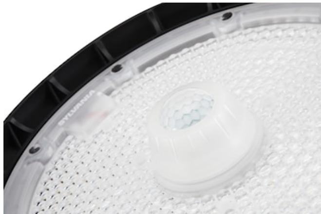
Granit G2 Module PIR. Accessoire pour armature industrielle Sylvania Granit Gen2. Capteur infrarouge PIR pour version 0-10V. Détection dans un rayon de 16m et 15m de hauteur (pour la détection des chariots élévateurs à fourche et détection des personnes jusqu'à une hauteur de montage de 12 m). Détection lumière du jour et des mouvements. Programmable par la télécommande code 9048800.
