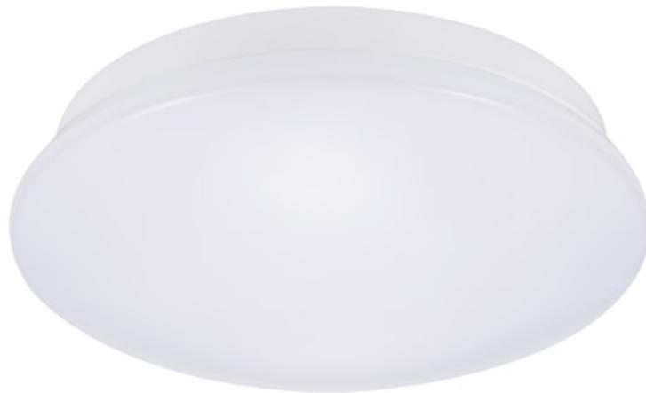
Hublot pour installation en intérieur, au mur ou au plafond. Puissance lumineuse (500lm à 2000lm) réglable avec driver multipower. Double température de couleur 3000K / 4000K sélectionnable par switch à l'installation. Efficacité jusqu'à 114lm/W. Équipé d'un détecteur MW (microwave) pour une gestion automatique en fonction de la présence et une prise en compte de la luminosité. Diamètre 300mm. Hauteur 94mm. IP54. IK03. Durée de vie 95.000 h (L80B20). Garantie 5 ans
