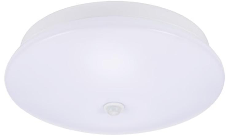
Hublot pour installation en intérieur, au mur ou au plafond. Puissance lumineuse (450lm à 1800lm) réglable avec driver multipower. Double température de couleur 3000K / 4000K sélectionnable par switch à l'installation. Efficacité jusqu'à 103lm/W. Équipé d'un détecteur PIR (infra-rouge) pour une gestion automatique en fonction de la présence et une prise en compte de la luminosité. Diamètre 300mm. Hauteur 105mm. IP54. IK03. Durée de vie 95.000 h (L80B20). Garantie 5 ans
