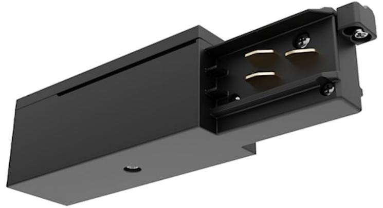
Accessoire OneTrack, alimentation terminale gauche. Corps en polycarbonate, contacts en alliage de cuivre. Couvercle pour version encastrée fourni séparément. Finition Noir. Veuillez vérifier le diagramme de polarité sur la fiche de vente.
