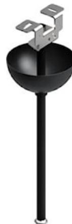
Accessoire OneTrack, kit de suspension complet comprenant : support plafond, tige filetée M13 (diamètre 13mm - longueur 1,2m) avec contre-écrou, coupelle plafond en métal noir (diamètre 100mm). SET7. Compatible avec Lytespan
