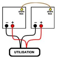
Le cablage préconisé pour la mise en parallèle est le suivant
