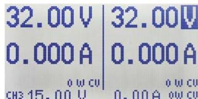
Dès que les sorties sont sur "ON" la mesure Tension et Courant s'affiche à la place de la consigne si elle est différente. Un simple appui sur les boutons de sélection V ou A permet d'afficher momentanément les consignes.
