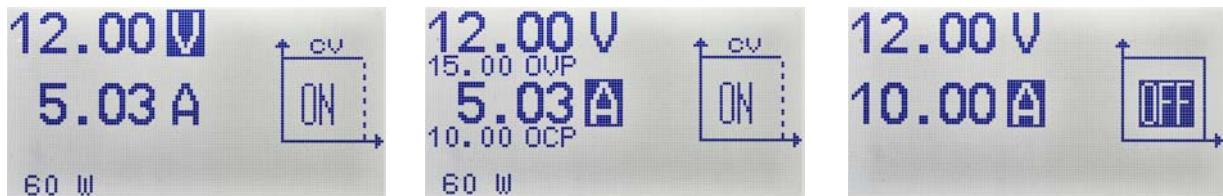
La mesure (Tension ou Courant) s'affiche à la place de la consigne si elle est différente. Un simple appui sur les boutons de sélection V ou A permet d'afficher momentanément les consignes.
