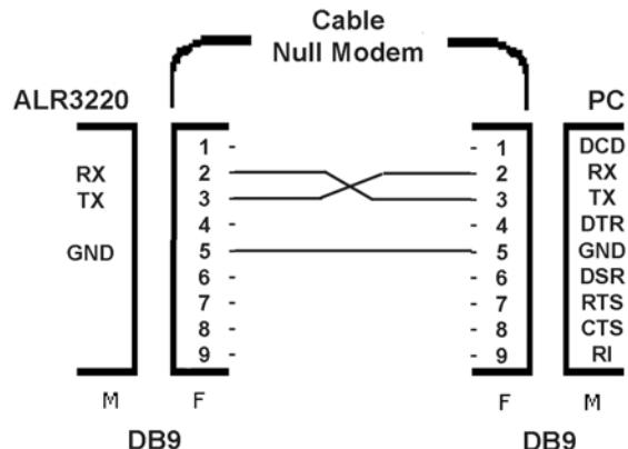
Préparation de la communication : Relier l'alimentation au port série du PC à l'aide d'un câble RS232 «null modem», (connexions croisées). Il est recommandé d'utiliser un câble blindé afin de minimiser les interférences provoquées par les données circulant entre l'appareil et le PC et sa longueur ne devra pas excéder 3 mètres.
