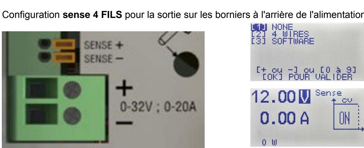
Les borniers "sense+" et "sense-" doivent être impérativement connectés sur les sorties + et -, au plus près de la charge.
