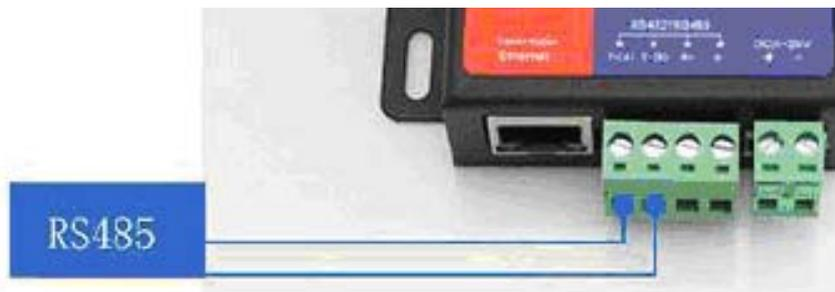
A l'aide du connecteur 4 broches, connecter les sorties à l'aide d'une paire de fils torsadés (non fournis) T+ et T- respectivement aux entrées D+ et D- de votre produit ELC équipée d'une entrée RS485 ( ALR3220, 3206D, 3206T,..).
