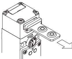
Chaque interrupteur comporte à l'intérieur un mécanisme permettant de maintenir l'actionneur en position fermée. Cela s'avère idéal pour toutes les applications impliquant le déverrouillage simultané de plusieurs protecteurs, mais l'ouverture effective d'un seul. Le mécanisme maintient en place tous les protecteurs déverrouillés avec une force d'environ 30 N, évitant ainsi que des vibrations ou des rafales de vent ne puissent les ouvrir.
