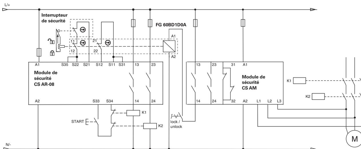
**Note** : les contacts normalement fermés de K1 et K2 sont guidés mécaniquement (EN 60947-4-1, annexe F)
