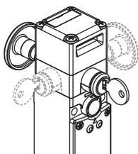
Ce dispositif effectue simultanément les deux fonctions indiquées ci-dessus. Même dans ce cas, le dispositif est orientable et le bouton de déverrouillage peut être commandé en différentes longueurs. L'activation du bouton a la priorité sur la serrure, c'est-à-dire qu'avec la serrure verrouillée, il est quand même possible d'actionner le bouton et de déverrouiller l'interrupteur. Pour réarmer l'interrupteur, il est nécessaire de remettre la serrure et le bouton dans leur position initiale.
