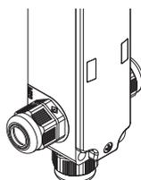
L'interrupteur est équipé de trois entrées de câbles dans des directions différentes. Cela permet de l'utiliser dans des connexions en série ou dans des endroits étroits.
