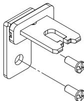
Conformément à la norme EN ISO 14119, l'actionneur doit être fixé au châssis du protecteur de façon inamovible. Des vis de sécurité à tête bombée, avec une empreinte one-way, sont disponibles à cet effet. Avec ce type de vis, les actionneurs ne peuvent être ni retirés ni forcés au moyen d'outils classiques. Voir Accessoires page 419.
