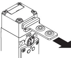
Le système d'interverrouillage résistant garantit une force de retenue maximale de l'actionneur  $F_{1max}$  égale à 3000 N.
