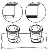
L'anneau façonné peut être utilisé s'il n'y a pas de porte-plaquettes ou d'autres dispositifs, il empêche le dépôt de saleté ou d'autres résidus entre le bouton et le panneau ou le boîtier.
