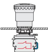
Spécialement conçu pour les boutons coup de poing d'arrêt d'urgence, le contact auto-surveillé permet d'atteindre un niveau d'autocontrôle élevé. Toutes les anomalies éventuelles, comme le détachement du contact du bouton d'arrêt d'urgence, seront immédiatement signalées par l'ouverture du circuit de sécurité. Ainsi, des défaillances difficiles à détecter seront tout de suite mises en évidence. En fait, le détachement
