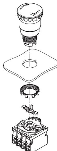
Le montage de l'actionneur pour base à 4
