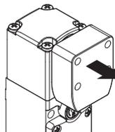
**9750 N** Le système robuste d'interverrouillage assure une force de retenue maximum de l'actionneur  $F_{1max}$  égale à 9750 N. Cette valeur est une des plus élevées actuellement présentes sur le marché, et rend le dispositif approprié pour des applications très lourdes.
