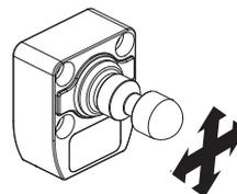
Tous les actionneurs de la série NG sont de type articulé et permettent au goujon de s'adapter au trou de centrage présent dans l'interrupteur. Aucune opération précise d'alignement actionneur-interrupteur n'est donc nécessaire pendant l'installation. De plus, grâce à sa flexibilité, l'actionneur peut être utilisé sur des protecteurs à rayon minimum d'actionnement de 150 mm, sans avoir à incliner le goujon au préalable.
