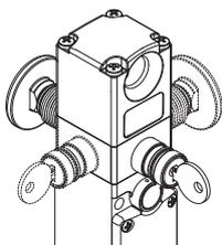
Le déverrouillage à serrure (auxiliary release) ne permet le déblocage de l'actionneur que par un personnel en possession de la clé d'actionnement. Le mécanisme fonctionne également en absence d'alimentation électrique et, une fois actionné, empêche le blocage de la protection.
