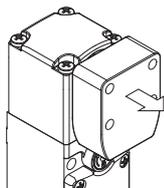
Chaque interrupteur comporte à l'intérieur un mécanisme permettant de maintenir l'actionneur en position fermée. Cela s'avère idéal pour toutes les applications impliquant le déverrouillage simultané de plusieurs protecteurs, mais l'ouverture effective d'un seul. Le mécanisme maintient en place tous les protecteurs déverrouillés avec une force d'environ 30 N, évitant ainsi que des vibrations ou des rafales de vent ne puissent les ouvrir.
