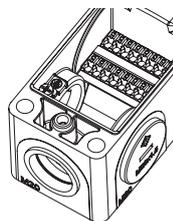
L'interrupteur est doté, à l'intérieur, d'un système de connexion à ressort de type PUSH-IN. Cette technologie permet de câbler facilement et rapidement, puisque la simple insertion du fil dans le trou prévu à cet effet permet de le fixer et d'établir le raccordement électrique. Cette opération pourra être effectuée sans l'aide d'aucun outil en utilisant des fils rigides ou flexibles à embout. Le décrochage se produit en revanche en appuyant sur la touche de relâche du fil prévue à cet effet.
