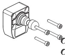
Chaque actionneur de la série NG est fourni avec quatre capuchons de protection à clipser. Ces capuchons préviennent l'accumulation de sédiments, facilitent le nettoyage et interdisent l'accès aux vis de fixation de l'actionneur. Il est donc possible d'utiliser des vis standard à la place des vis anti-effraction.
