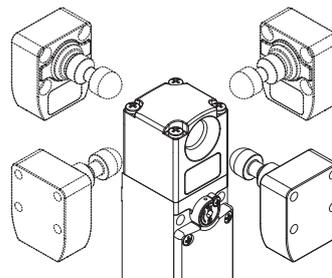
La tête peut être rapidement positionnée des quatre côtés en agissant sur les 4 vis de fixation. Les dispositifs de déverrouillage à serrure et le bouton de déverrouillage antipanique peuvent aussi être orientés par pas de 90°, permettant ainsi d'obtenir, avec un seul même article, 16 configurations différentes.
