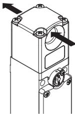
L'interrupteur présente un trou traversant pour l'insertion de l'actionneur. C'est grâce à cette particularité que la poussière qui pourrait éventuellement pénétrer dans l'orifice de l'actionneur a toujours la possibilité de sortir du côté opposé, au lieu de rester à l'intérieur. En outre, le goujon de verrouillage est équipé d'un joint à membrane externe qui permet de l'utiliser dans des endroits poussiéreux.
