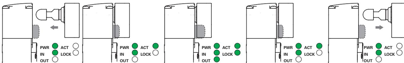
L'interrupteur est alimenté (LED PWR allumée en vert), les entrées IS1, IS2 sont activées (LED IN allumée en vert), les sorties de sécurité OS1, OS2 sont désactivées (LED OUT éteinte). L'actionneur est à l'extérieur de la zone d'actionnement (LED ACT éteinte).
