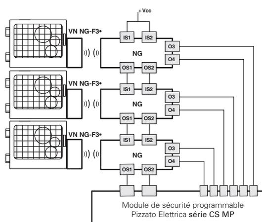
Possibilité de connexion en série de plusieurs interrupteurs pour simplifier le câblage du système de sécurité avec l'évaluation préalable des sorties de dernier interrupteur de la chaîne par un module de sécurité Pizzato Elettrica de la série CS MP qui permet de gérer soit la partie de sécurité soit celle de signalisation.
