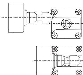
L'interrupteur est équipé d'une large entrée de centrage pour le goujon de l'actionneur. Cette solution facilite l'alignement entre l'actionneur et le trou présent dans la tête au cours de la phase de montage. De plus, elle réduit considérablement la probabilité de collision entre l'actionneur et l'interrupteur, ce qui permet son installation même sur des portes à fermeture imprécise.
