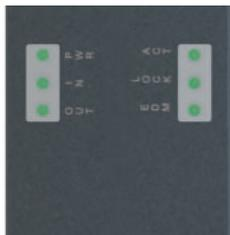
Conçu pour un diagnostic rapide et simple, l'état de chaque entrée et sortie est signalé par une LED. De cette façon, vous pouvez rapidement localiser les points d'interruption de la chaîne sécurisée, quel dispositif est déverrouillé, quelle porte est ouverte et les erreurs à l'intérieur du dispositif. Le tout d'une façon immédiate, sans avoir à décoder des séquences complexes de clignotement.
