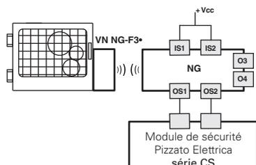
L'interrupteur de la série NG peut être utilisé individuellement après avoir évalué les sorties de sécurité par un module de sécurité de Pizzato Elettrica (voir le tableau des modules de sécurité compatibles).
