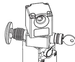
La tête et les dispositifs de déverrouillage sont orientables, mais ne peuvent pas être détachés l'un de l'autre. De cette manière, l'interrupteur est plus sûr, car l'installateur ne doit pas se soucier de la manière dont il doit assembler les différentes pièces et la probabilité que l'interrupteur soit endommagé est moindre (perte de petites pièces, entrée de saleté, etc.).
