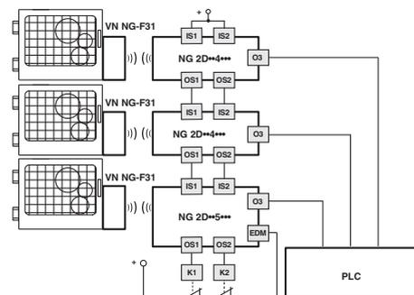
Cette version dispose d'entrées de sécurité IS et, tout en maintenant le niveau de sécurité maximal PL e spécifié dans la norme EN 13849-1 et SIL 3 spécifié dans la norme EN 62061, elle **peut être ajoutée à la fin d'une série de jusqu'à 32 interrupteurs NG**.
