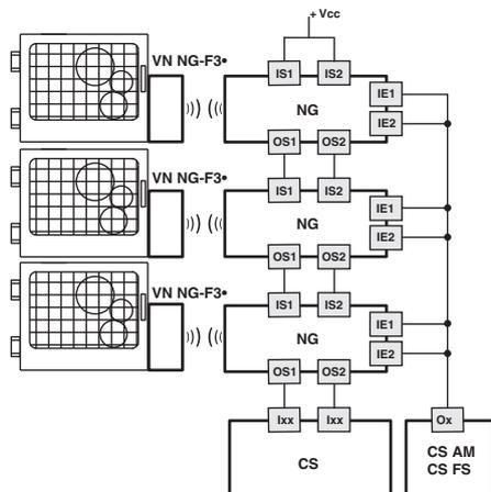
Fonction de surveillance de l'actionneur verrouillé
