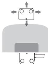
Grâce à leurs caractéristiques intrinsèques, les capteurs magnétiques sont équipés d'une grande zone d'actionnement qui les rend très appréciés pour l'utilisation avec des protections imprécises ou des protections dont les caractéristiques mécaniques peuvent changer au cours du temps.
