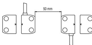
Il est possible d'installer plusieurs dispositifs sur la même machine. La distance minimale de montage entre les systèmes capteur-actionneur est de seulement 50 mm.
