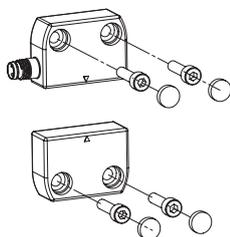
Chaque capteur et actionneur de la série SR A est fourni avec des capuchons de protection à clipser dans les trous des vis de fixation. Ces capuchons préviennent l'accumulation de sédiments, facilitent le nettoyage et interdisent l'accès aux vis de fixation de l'actionneur. Il est donc possible d'utiliser des vis standard à la place des vis anti-effraction.
