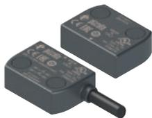
Les capteurs magnétiques codés sont des appareils indiqués pour le contrôle des protections et protecteurs des machines sans inertie. Lorsqu'ils sont associés à un module de sécurité spécial, ils sont en mesure de créer un système ayant une catégorie de sécurité allant jusqu'à SIL 3 selon EN 62061, jusqu'à PL e selon EN ISO 13849-1 et jusqu'à catégorie 4 selon EN ISO 13849-1.
