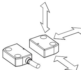
Les capteurs magnétiques codés ont été étudiés pour pouvoir être actionnés par leur actionneur respectif dans plusieurs directions.
