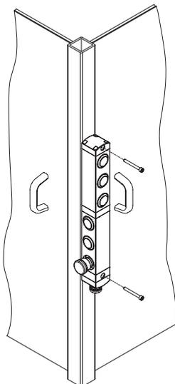
Grâce à leur structure composée de modules rotatifs, les boîtiers de commande de la série BN offrent à l'utilisateur un large éventail de possibilités de fixation à la machine.
