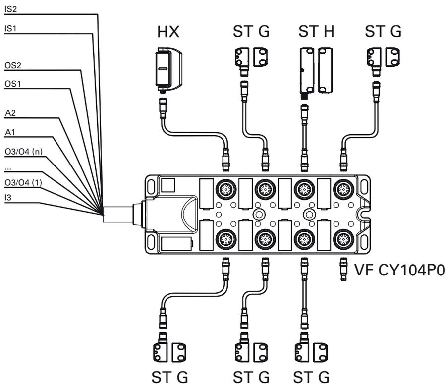
**Note :** Les sorties O3/O4 indiquent l'état fermé (O3) du protecteur pour les dispositifs des séries ST et HX et l'état fermé et verrouillé (O4) du protecteur pour les dispositifs des séries NS et NG.
