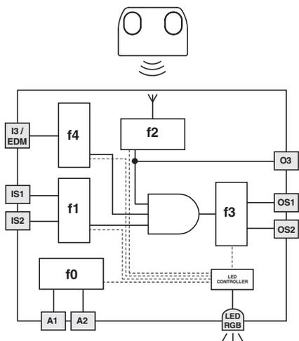
Le schéma à côté représente les 5 fonctions logiques qui interagissent dedans le capteur. La fonction f0 est une fonction globale qui surveille l'alimentation du capteur et les tests internes auxquels il est soumis cycliquement.
