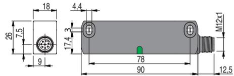
Capteur ST G••••M0.2 avec câble et connecteur M12
