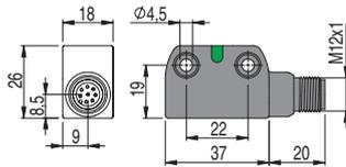
Capteur ST H••••M• avec connecteur M12
