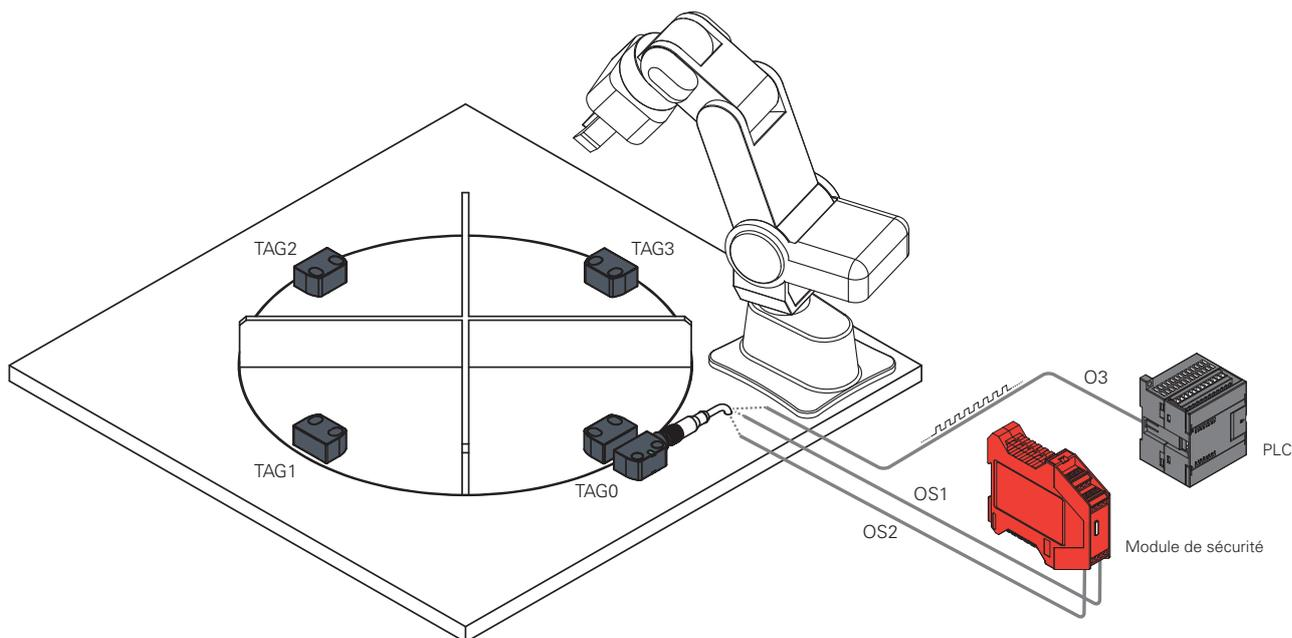
L'article ST G.....-P4 contient un capteur fourni avec quatre actionneurs.
