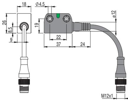
Capteur ST H••••M0.2 avec câble et connecteur M12
