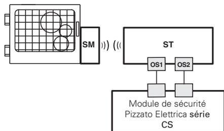
Le capteur de la série ST peut être utilisé individuellement après avoir évalué les sorties par un module de sécurité de Pizzato Elettrica (voir le tableau des modules de sécurité compatibles).
