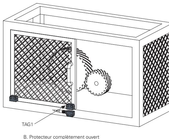
L'article **ST G•••••-P1** contient un capteur fourni avec deux actionneurs.
