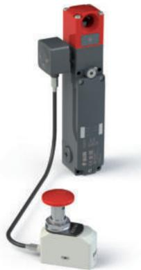
Les interrupteurs de sécurité NG et NS avec déverrouillage de fuite à distance sont fournis avec le dispositif correspondant monté sur la tête de l'interrupteur et un câble en acier robuste long de 5 mètres dans une gaine avec âme en acier.
