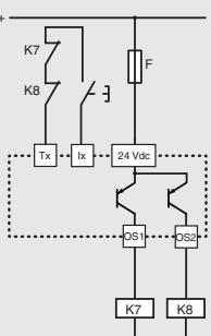
Per un corretto funzionamento eventuali moduli o PLC connessi alle uscite sicure elettroniche OSx devono tollerare i test ciclici di disattivazione che vengono effettuati sulle medesime.
