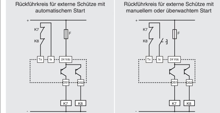
Für den ordnungsgemäßen Betrieb müssen Module oder eine SPS, die möglicherweise an die elektronischen OSx Sicherheits-Ausgänge angeschlossen sind, zyklisch
