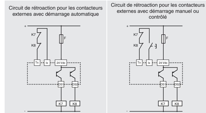
Pour un fonctionnement correct, tout module ou automate connecté aux sorties électroniques de sécurité OSx doit tolérer les tests cycliques de désactivation qui y sont effectués.
