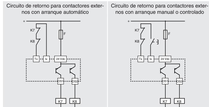
Para un funcionamiento correcto, cuando hay módulos o PLC conectados a las salidas
