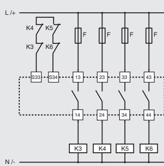
Circuit de rétroaction pour les contacteurs externes avec démarrage manuel ou contrôlé
