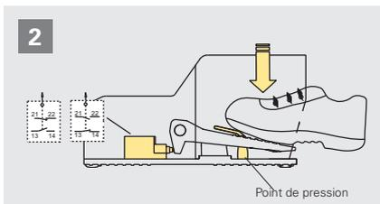
Avec une légère pression (~19 N) sur l'actionneur de la pédale, un des deux blocs de contact commute alors que l'autre garde son état inchangé. L'actionneur de la pédale s'arrête contre le point de pression.
