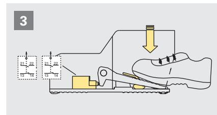
En appuyant avec une force plus grande (~180 N) sur l'actionneur de la pédale, l'autre bloc de contact commute aussi. Dans cette position, les deux blocs de contact sont commutés.
