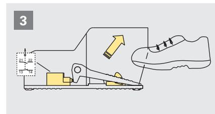
En relâchant l'actionneur de la pédale, le dispositif de blocage le maintient abaissé.
