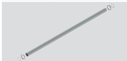
Kit tube Ø 25 mm en métal à extrémités filetées M25x1,5 (pour VF KIT32, VF KIT33, VF KIT34, VF KIT35) complet avec écrous en métal et garnitures. Degré de protection IP65.
