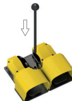
En plus de la possibilité d'assembler deux à quatre pédales simples, les dispositifs d'assemblage permettent d'utiliser un tube en métal pour le raccordement électrique entre les contacts des pédales et les contacts d'un bouton coup de poing d'arrêt d'urgence, relié au même tube, en conservant le degré de protection IP65.
