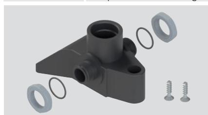
Kit d'assemblage pour pédales en technopolymère avec trou fileté M25x1,5 pour VF KIT31 ou VF KIT29 complet avec écrous, garnitures et vis auto-taraudeuses pour la fixation de deux pédales simples.
