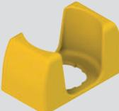
VE GP32F5A | Garde de protection rectangulaire ouvert jaune 66x38 h35 mm équipé de 4 vis (pour panneaux allant de 1 à 3,5 mm d'épaisseur)<br>Applicable au joystick à deux directions de hauteur standard et réduite. |
