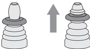
Pour éviter tout actionnement accidentel, le joystick peut être demandé dans les versions avec verrouillage central. Dans ces versions, le levier reste fixe en position centrale et peut être manœuvré dans
