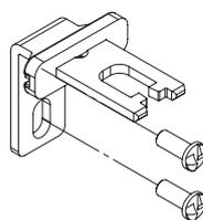
Conformément à la norme ISO 14119, l'actionneur doit être fixé au châssis du protecteur de façon inamovible. Des vis de sécurité à tête bombée, avec une empreinte one-way, sont disponibles à cet effet. Avec ce type de vis, les actionneurs ne peuvent être ni retirés ni forcés au moyen d'outils classiques. Voir Accessoires page 359.
