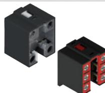
Bloc de contact avec vis imperdables, protège-doigts et contacts à double pont et double coupure pour une plus grande fiabilité de contact. Versions disponibles avec contacts dorés. Disponibles en de nombreuses variantes actionnées par l'actionneur ou par l'électroaimant.
