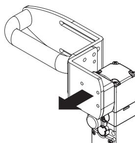
**9750 N** Le système robuste d'inter-verrouillage assure une force de retenue maximum de l'actionneur  $F_{\text{max}}$  égale à 9750 N. Cette valeur est une des plus élevées actuellement présentes sur le marché, et rend le dispositif approprié pour des applications très lourdes.
