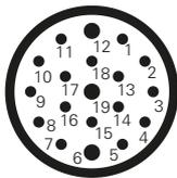
Pour le raccordement du bloc de contact de l'interrupteur au connecteur M23 à 19 pôles, voir la numérotation des broches 1 à 10 sur les schémas de la page 156.
