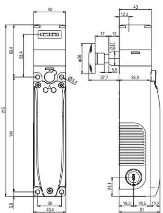
**Interrupteur FY 6••••••••** avec dispositifs de commande intégrés
