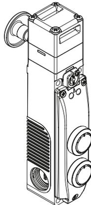
L'interrupteur est également disponible dans des versions à dispositifs de commande intégrés qui permettent de monter jusqu'à 2 dispositifs avec les blocs de contact correspondants (ex. boutons, boutons d'arrêt d'urgence, indicateurs lumineux ou sélecteurs).
