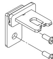
Conformément à la norme EN ISO 14119, l'actionneur doit être fixé au châssis du protecteur de façon inamovible. Des vis de sécurité à tête bombée, avec une empreinte one-way, sont disponibles à cet effet. Avec ce type de vis, les actionneurs ne peuvent être ni retirés ni forcés au moyen d'outils classiques. Voir Accessoires page 419.
