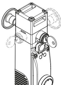
Le déverrouillage à serrure (auxiliary release) ne permet le déblocage de l'actionneur que par un personnel en possession de la clé d'actionnement. Le mécanisme fonctionne également en absence d'alimentation électrique et, une fois actionné, empêche le blocage de la protection.
