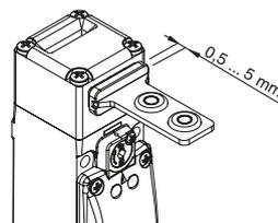
Cet interrupteur dispose d'un grand jeu de l'actionneur dans la tête. De cette manière, le protecteur peut bouger dans le sens d'insertion (4,5 mm) sans provoquer d'arrêt non souhaité de la machine. Tous les actionneurs présentent ce jeu qui permet de garantir la fiabilité optimale du dispositif.
