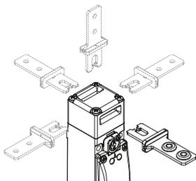
La tête peut être rapidement positionnée des quatre côtés en agissant sur les 4 vis de fixation.
