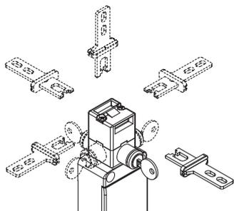
Le dispositif de déverrouillage auxiliaire est utilisé pour permettre l'entretien ou l'entrée dans la machinerie seulement au personnel autorisé. En tournant la clé, on effectue la même action que l'électroaimant, c'est-à-dire que les contacts de l'électroaimant se déplacent et l'actionneur se déverrouille. Le dispositif est orientable et cela permet d'installer l'interrupteur de sécurité à l'intérieur de
